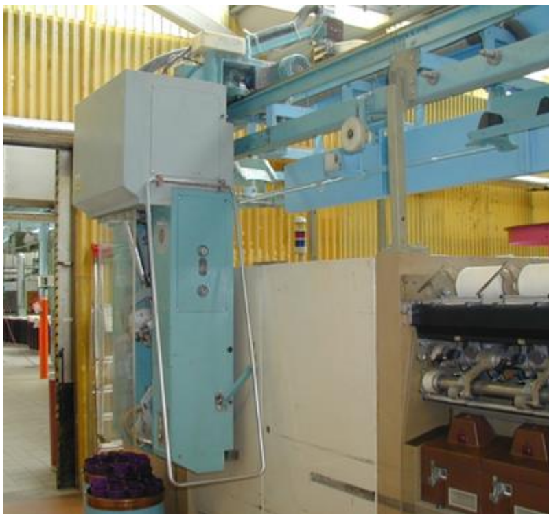
AČZ 10 – automatické čisticí a zapřádací ústrojí pro stroj BDA 10
