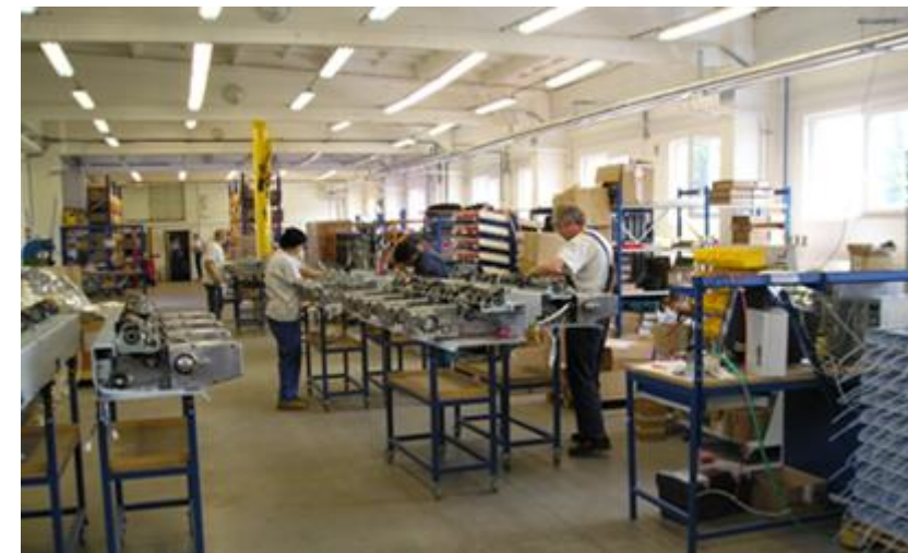
Montáž sekcí CP 10 v „garážích“ pro francouzskou textilní firmu RTMF
