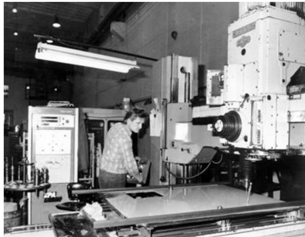
První zakoupený NC stroj – vrtačka VR5 NC se systémem NS 316
