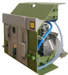
Rotorová jednotka Spinnbox R20
