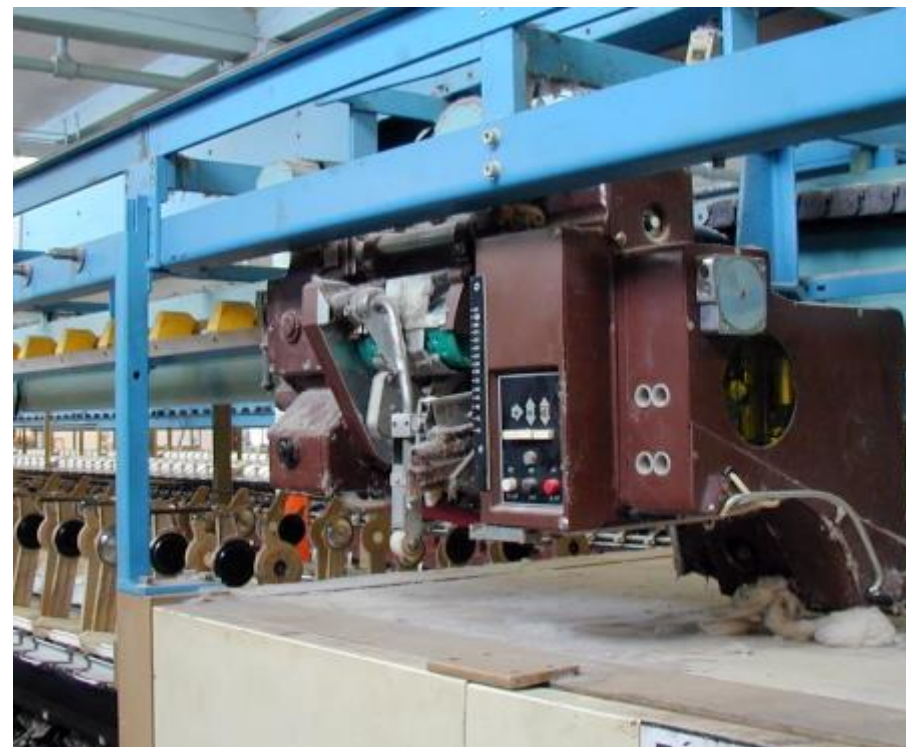
SMZ 10 – smekací zařízení návinnu dutinek dopřádacího stroje BDA 10
